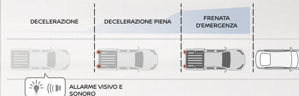
**Dispositivo frenata di emergenza intelligente (IEB).** Un radar integrato nel paraurti anteriore misura la distanza che ti separa dalla vettura che precede. Se individua il rischio di una collisione, emette un segnale sonoro e visivo. Se il conducente non reagisce, il dispositivo frena automaticamente il veicolo per evitare impatti.
