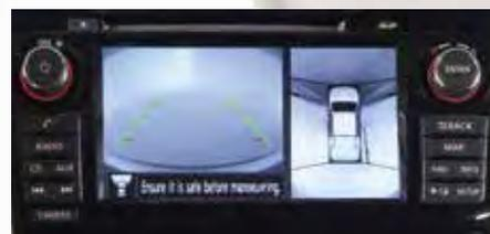
**Intelligent Around View Monitor.** Quattro telecamere forniscono l'immagine virtuale a 360° del veicolo, con la possibilità di visualizzare in dettaglio l'immagine frontale, posteriore e laterale ad altezza marciapiede. Funziona anche a una velocità di 10 km/h per permetterti di controllare le manovre su strada o evitare ostacoli nell'off road.
