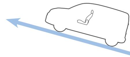
**HILL START ASSIST** Per evitare arretramenti in caso di partenza in salita, il dispositivo Hill Start Assist tiene premuto il freno per qualche secondo e ti dà il tempo di spostare il piede sull'acceleratore.
