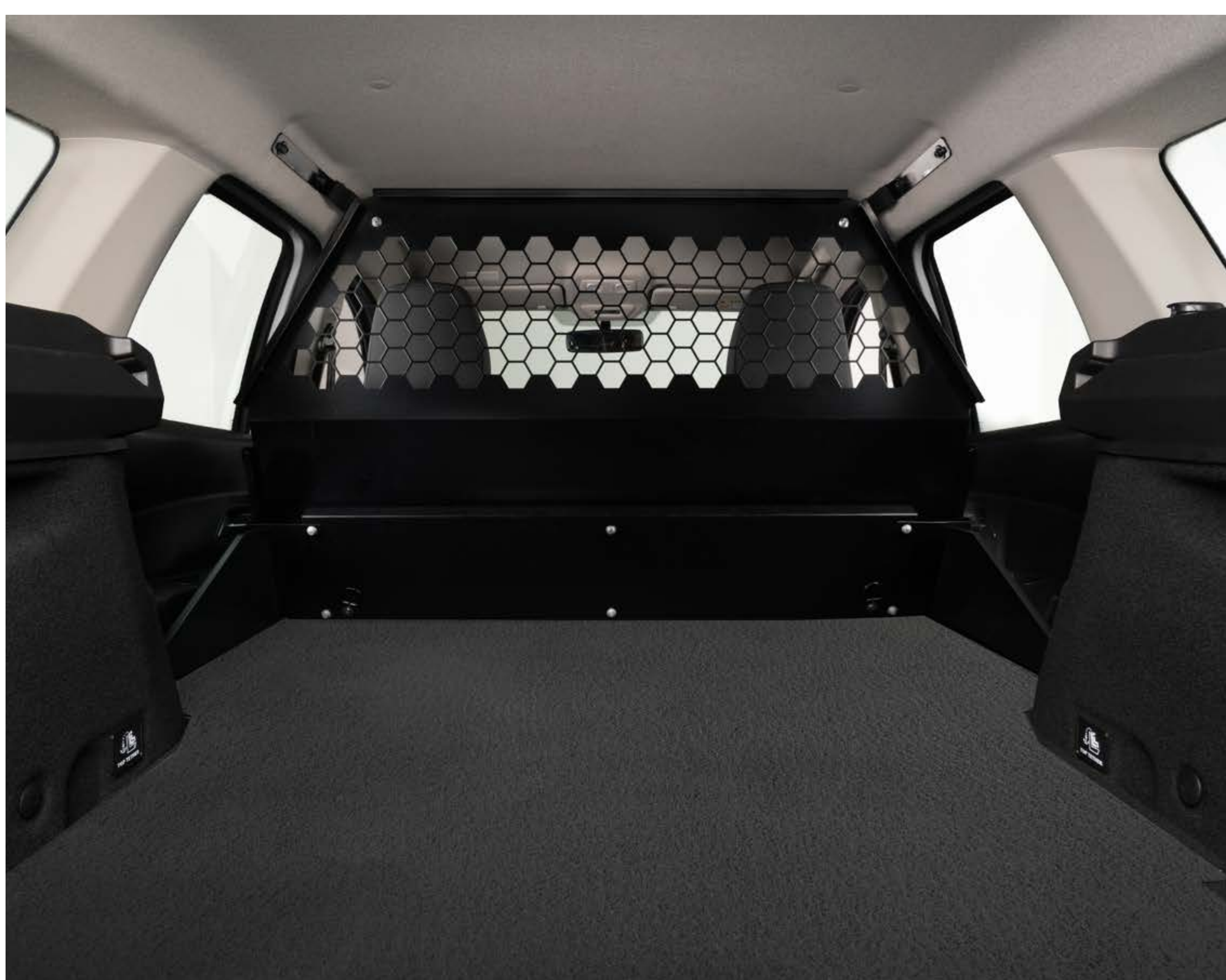
Pianale in legno protetto da un tappetino in gomma e paratia fermacarico inferiore lamierata
