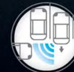
**IL SISTEMA DI RILEVAMENTO POSTERIORE DEGLI OSTACOLI\*\*** aiuta a muoversi in retromarcia in modo più sicuro. Monitora la parte posteriore della tua LEAF e segnala la presenza di vetture in avvicinamento su entrambi i lati.
